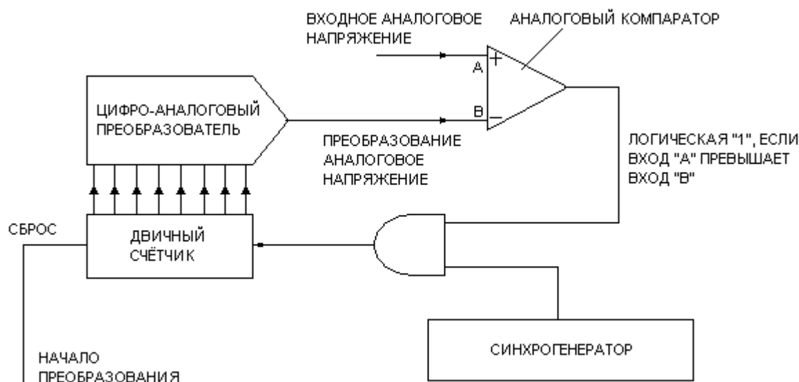
Рисунок 15.2 - Аналого-цифровой преобразователь с суммирующим счётчиком
